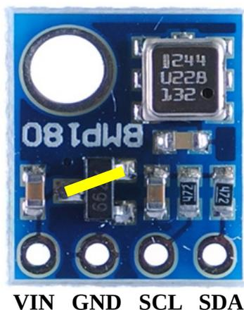
Für eine geringere Stromaufnahme sind die beiden Widerstände von 4.7kOhm ersatzlos zu entfernen. Der Spannungsregler (SOT23 mit Beschriftung 662K o.ä.) wird entfernt und durch eine Brücke von Mitte links zu oben rechts ersetzt. Das Modul kann direkt mit SCL und SDA auf den Pfostenstecker (Pin17/18) gelötet und mit zwei Drähten mit Spannung versorgt werden (VIN an +3.3V, GND an GND). Der Sensor wird automatisch vom Logger erkannt. Er sollte die Außenwelt „sehen“ können (Bohrloch im Deckel).
