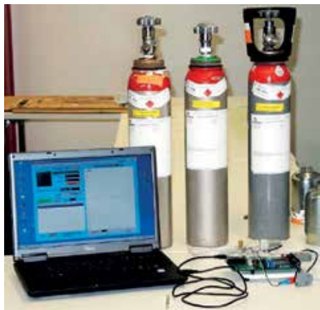
Abb.2: Drei Stahlflaschen mit professionell gemischten Gasproben zur Kalibrierung des Gaschromatographen vorne rechts.
