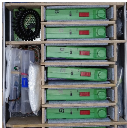
Foxoring-Koffer 1: von links oben nach unten ein Stempel, das Kontrollgerät, die Sender, ein Dreieckstuch zum Blindpeilen und der zweite Stempel
