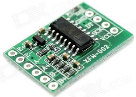
Bild: Der AD-Wandler HX711 als Herzstück der Messbox
