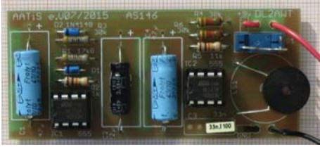
Bild: Probeaufbau der Sirene mit 2x NE555
