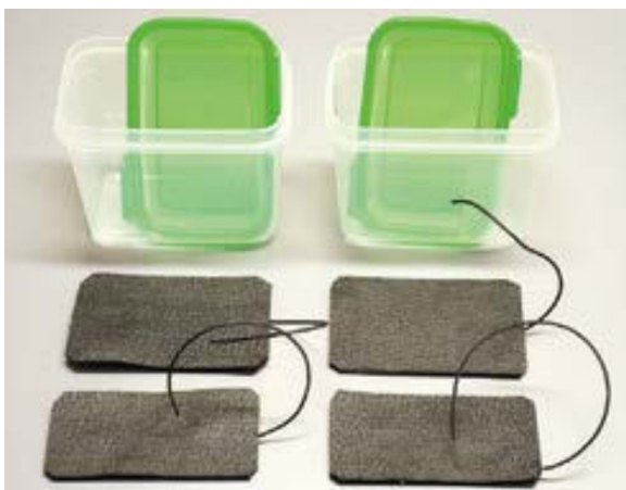
Abb. 7: Plastikdosen und GraphitWeichfilz-Elektroden vor der Befüllung
