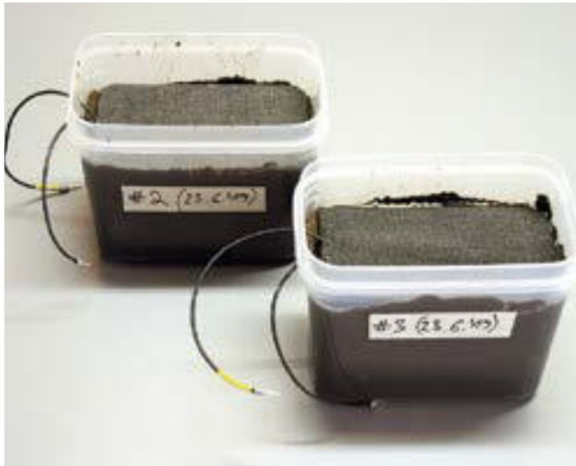
Abb. 8 : Zwei befüllte Schlamm-Batterien
