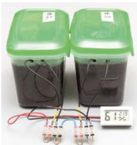
Abb. 3: Betrieb des im Bausatz enthaltenen Thermo-/ Hygrometers über zwei Schlamm-Batterie-Zellen
