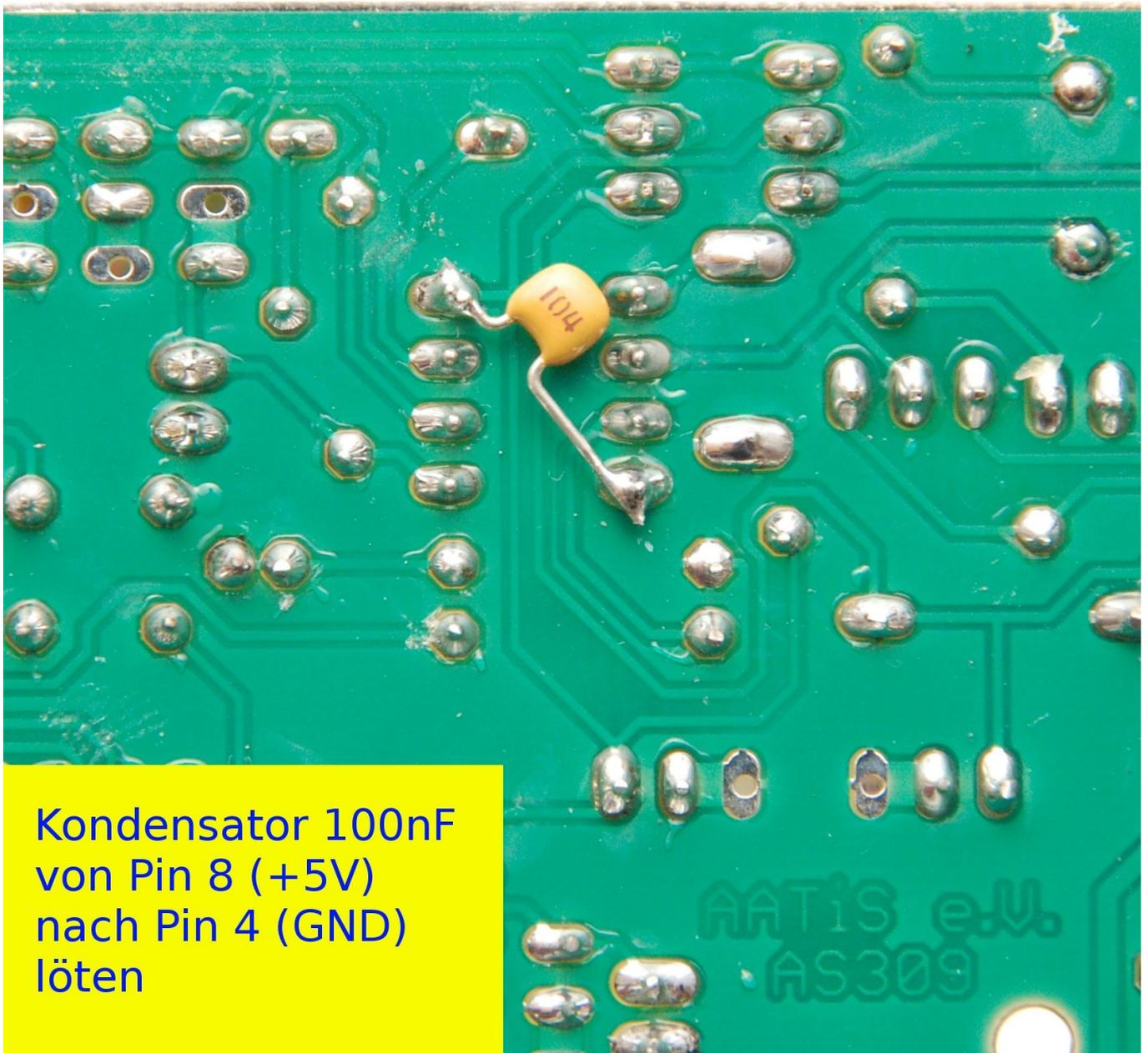
Bild 1 : Einbauposition des nachzurüstenden Kondensators.
