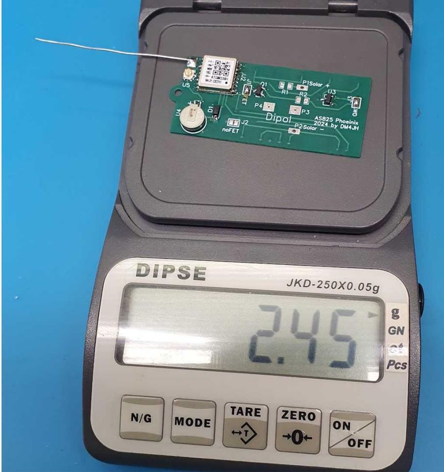
Fertige Platine (ohne Rpi) mit installierter GPS-Batterie und Antenne
